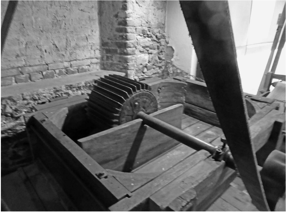
Abb. 9: Holländer einer Papiermühle [Vortaunusmuseum Oberursel]
