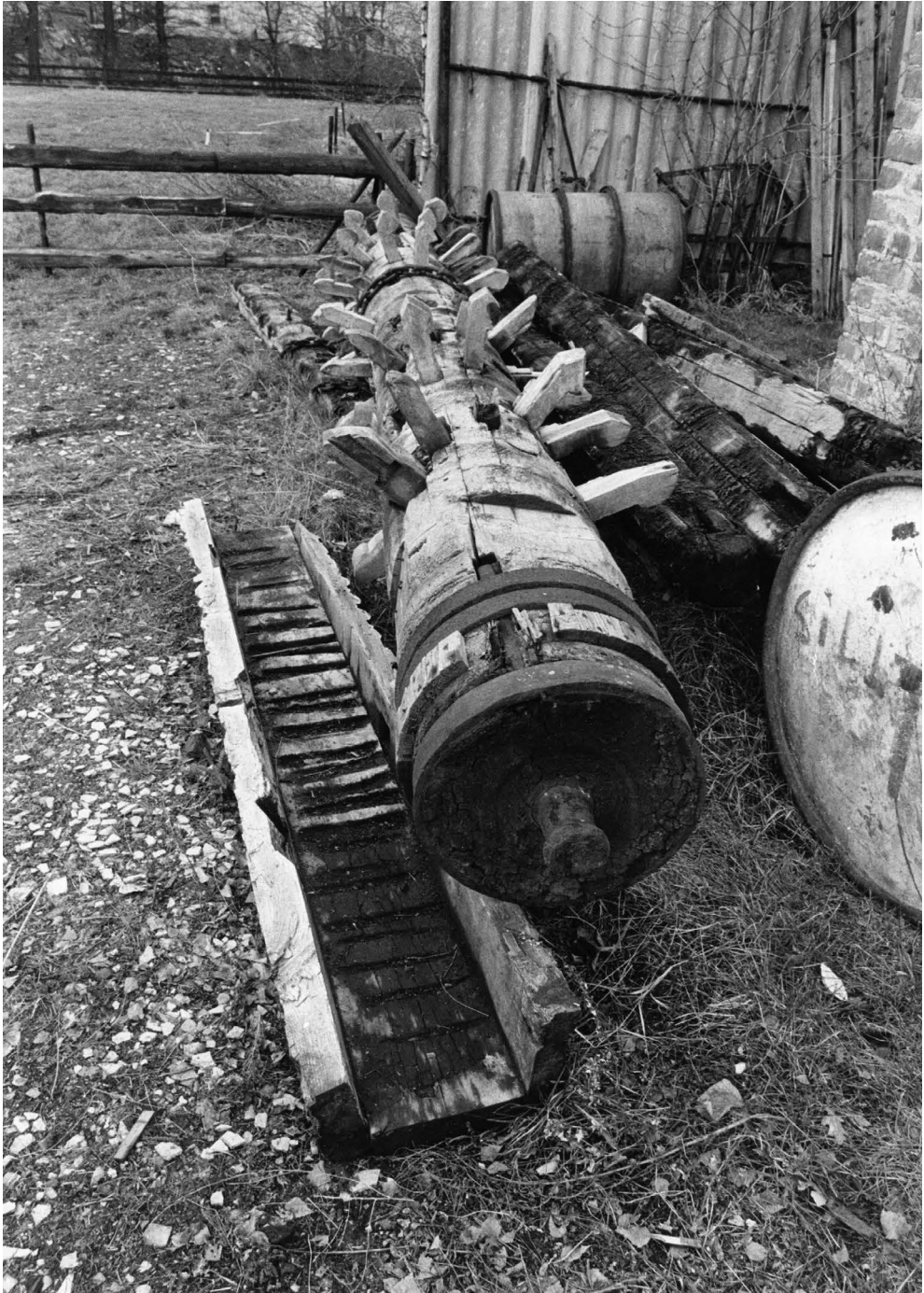
Abb. 3: Daumenwelle einer Tabakmühle in Frankfurt-Niederursel [ISG, S 7C 1998/820]
