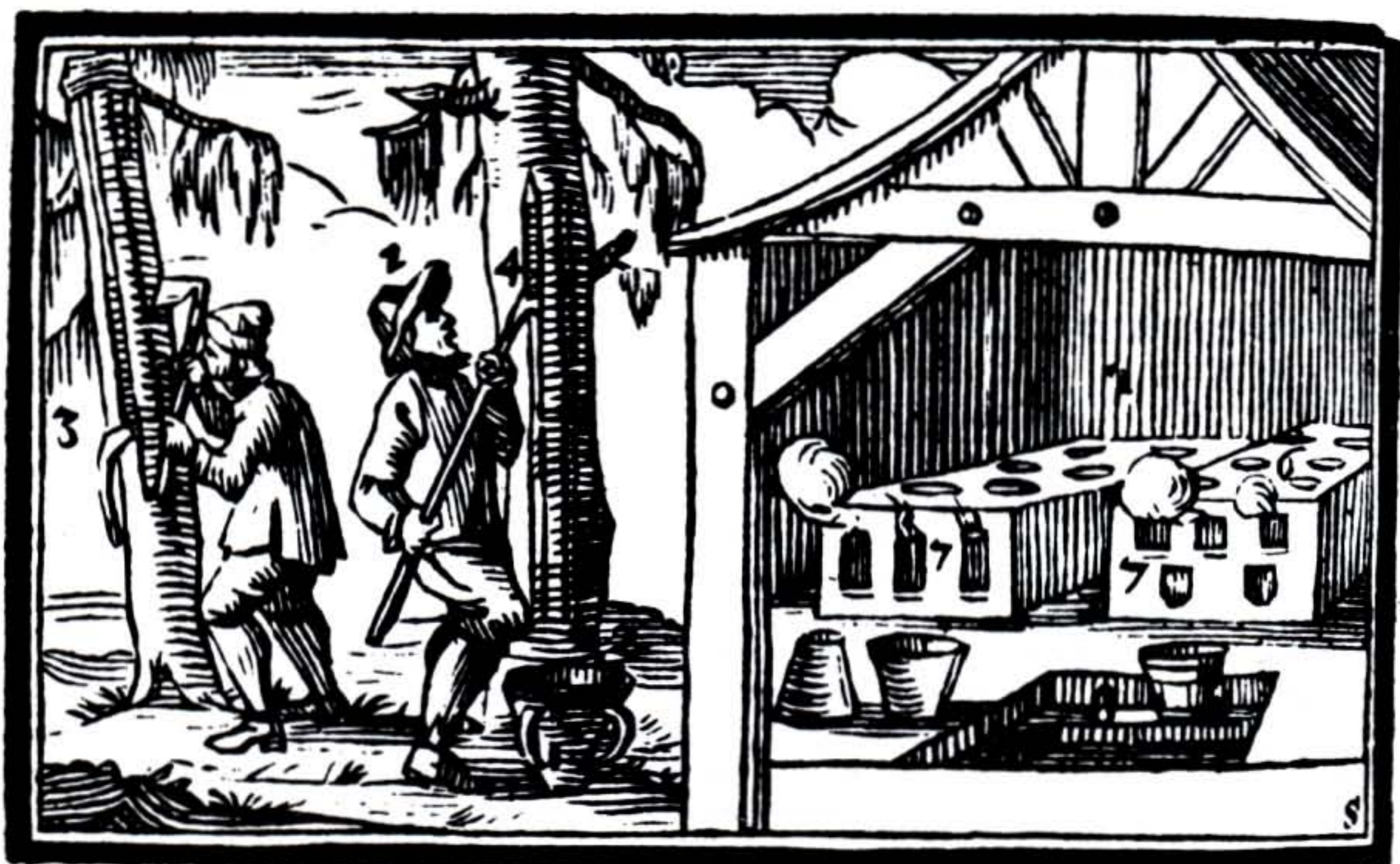
Abb. 7 Darstellung der Harzgewinnung durch Anreißen von Nadelbäumen und Einsieden des Harzes zu Pech in einer Pechhütte (nach Comenius, Abb. S. 28 - Erläuterungen zu den Ziffern siehe Anm. 130)
